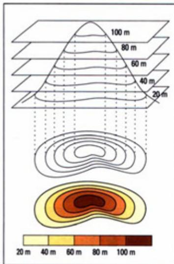
« Pour représenter le relief avec précision, on utilise les courbes de niveau, dites des isolignes, qui figurent les intersections imaginaires des formes du terrain avec des plans parallèles, séparées par des altitudes régulières. »
