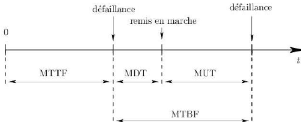
FIG. IV.1 - Schéma général de la fiabilité d'un élément
